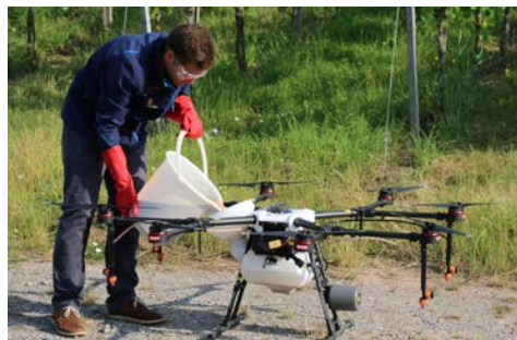
Abb. 2: Befüllung des DJI Agras MG-1P mit Pflanzenschutzmittel
