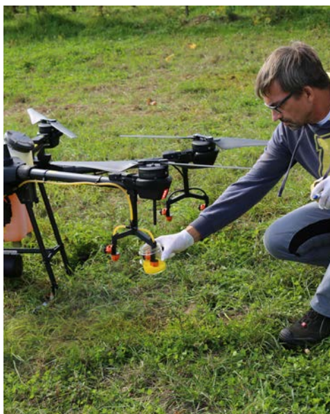
Abb. 9: Abdriftmessungen mit Unterstützung des LTZ Augustenberg
